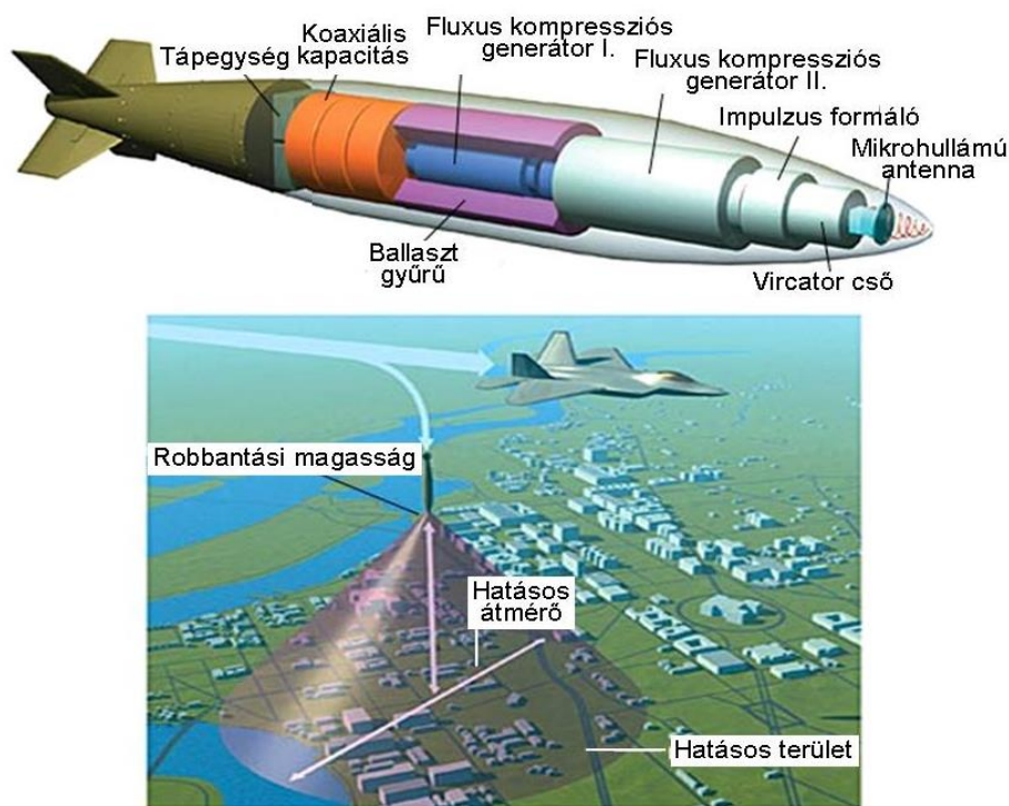
4. ábra. E-bomba felépítés és alkalmazása [42]
