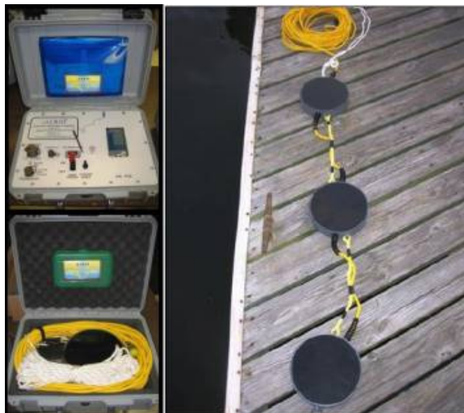
10. kép. Víz alatti akusztikus akadály [18]
