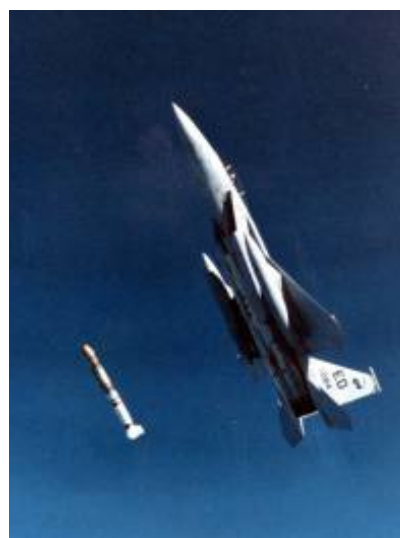
3. kép. Az ASM-135 műhold elleni rakéta és indítása [8]
