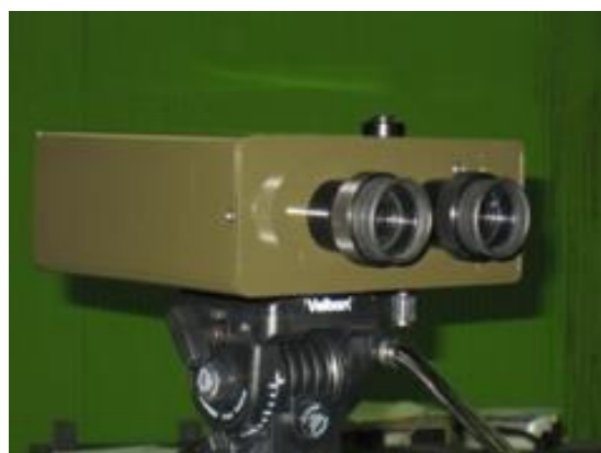
20. kép. Civil és katonai célú lézeres távmérő [37], [38]
