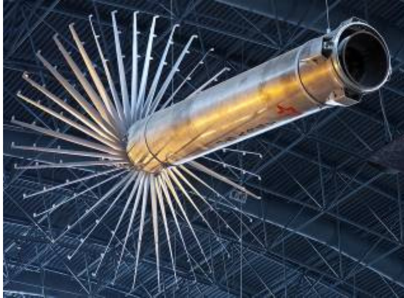
4. kép. A Homing Overlay Experiment szerkezete nyitott karokkal. [9]
