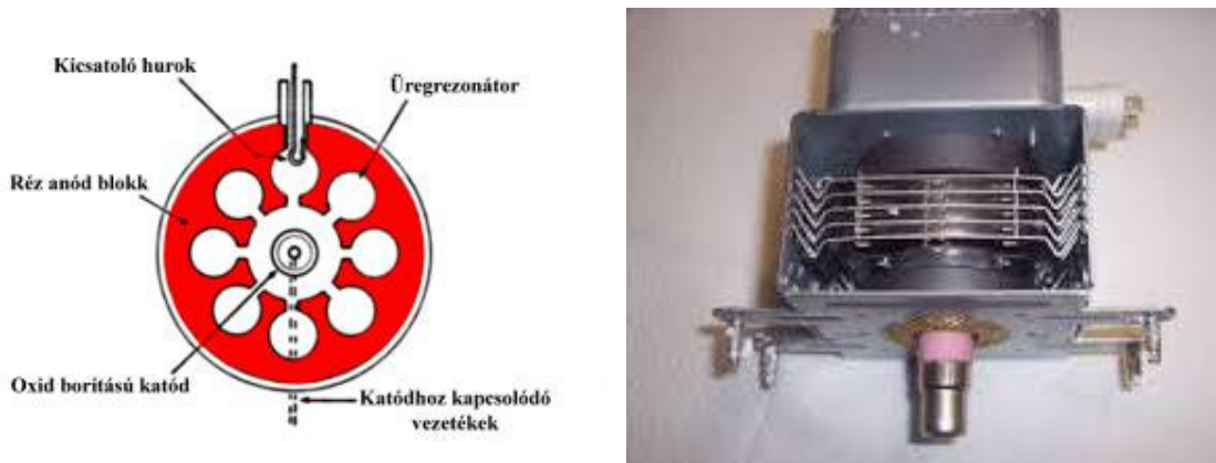
11. ábra. A magnetron vázlatos felépítése és egy gyári példány
