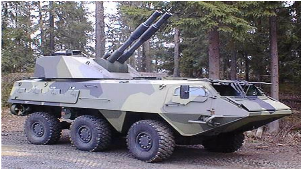
4. kép AMOS önjáró duplacsövű aknavető
