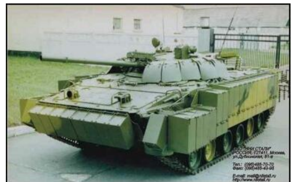
8. Kép: BMP-3 harcjármű „Kaktus” ERA-val felszerelve 21
