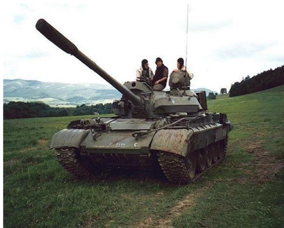
4. Kép: Korszerűsített T-55 harckocsi, a torony előtt, a homlokpáncélon kiegészítő páncélzattal 4
