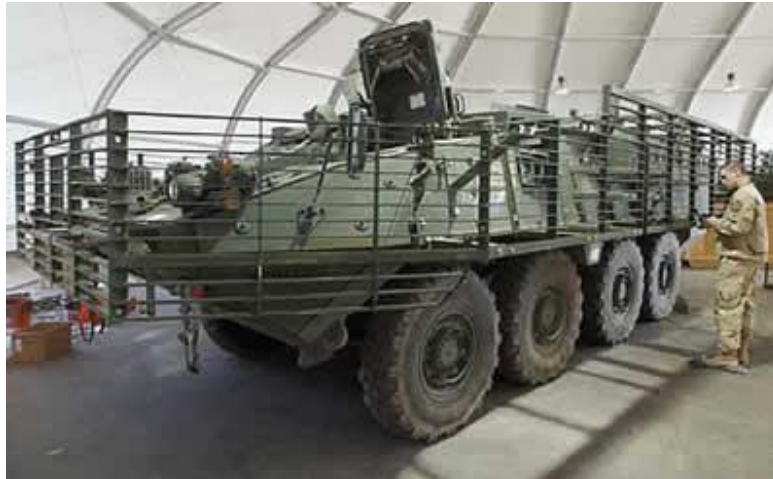
9. Kép: Stryker harcjármű „ketrec” kiegészítő páncélzattal 10
