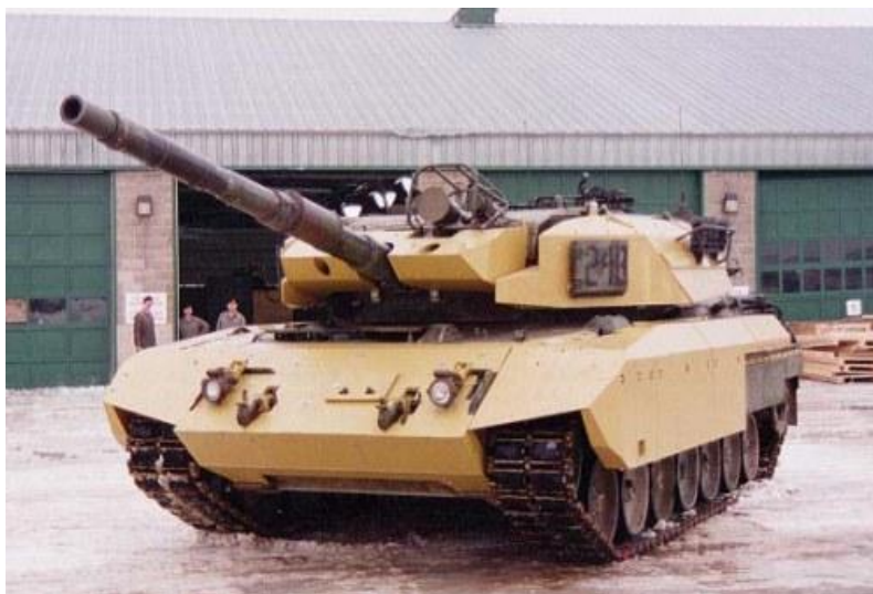
5. Kép: Leopard-1 harckocsi utólag felszerelt kiegészítő páncélzattal 5
