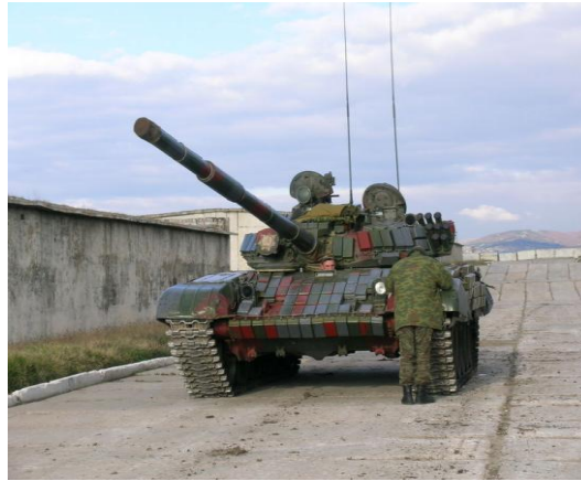
12. Kép: ERA-val felszerelt T-72 harckocsi 12
