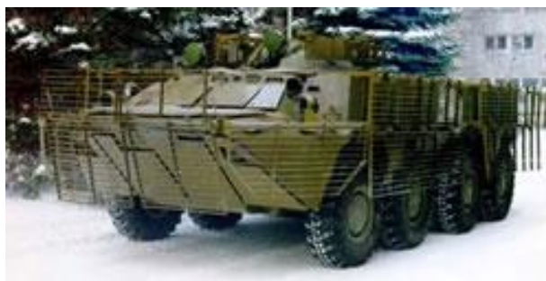
8. Kép: Kiegészítő páncélzattal felszerelt orosz BTR-80 Csecsinában 9
