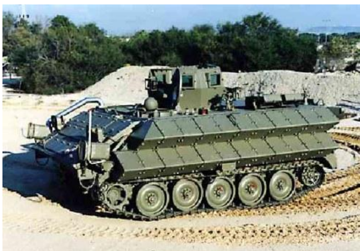
16. Kép: Egy izraeli M113-as reaktív páncéltűvel felszerelve 19
