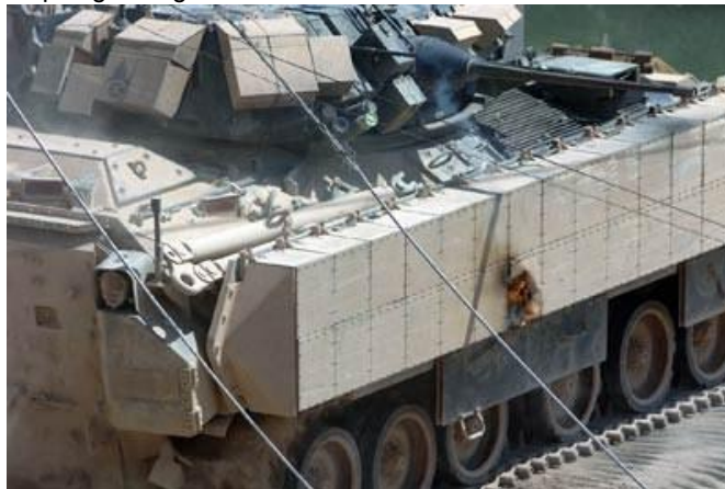
17. Kép: Egy reaktív páncélzattal felszerelt Bradley harcjármű Irakban. Az ERA megállította az RPG lövedéket 20
