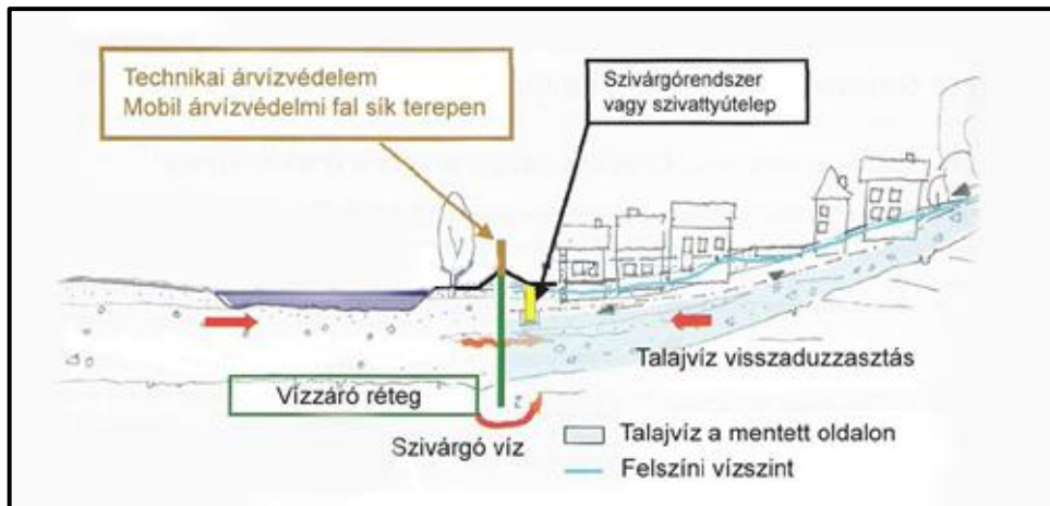
31. sz. ábra: A mobil árvízvédelmi falak vízzáró alépítményeinek talajvízáramlásra gyakorolt hatása.
