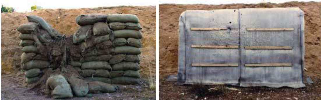
66. sz. ábra. A beton-vászonnal takart lőállás tesztje (forrás: http://www.concretcanvas.co.uk/Images/ccsgallery/index.html 2010.11.10)
