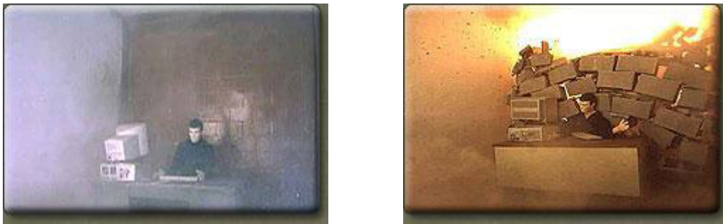
35. sz. ábra. Line-X-szel bevont és hagyományos falazat robbanás utáni állapota (forrás: http://www.linex.com/pages/2010/military/products/px_3350.php 2011. 05.05)
