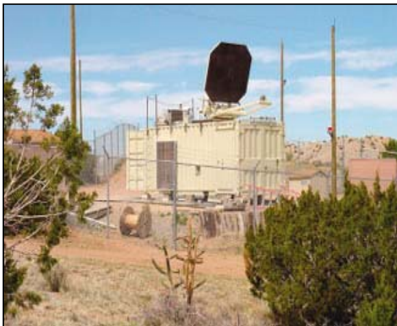
20-21. kép – A stabil (fix), valamint a mobil változatú aktív, behatolást megakadályozó rendszer
